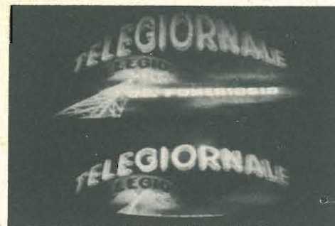
Fig. 4 - L'immagine è scomposta in due semi-immagini che possono essere ferme sullo schermo o scorrere lentamente dall'alto al basso o viceversa. Talvolta l'immagine può scorrere verticalmente in modo veloce. Suono normale.
