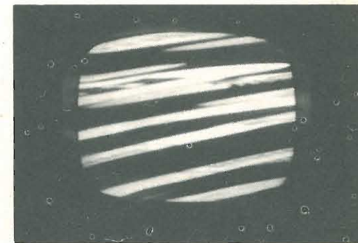
Fig. 1 - Agendo sui normali comandi esterni non è possibile ottenere il sincronismo orizzontale. Suono normale.
