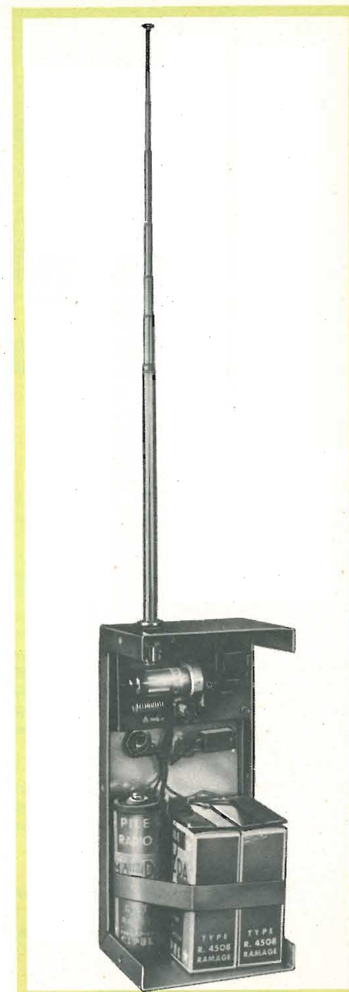
Fig. 4 - Trasmettitore TX-10 completo. In alto è visibile il circuito stampato dell'apparato trasmettitore, in basso si notano le batterie per l'alimentazione anodica e per il filamento.
